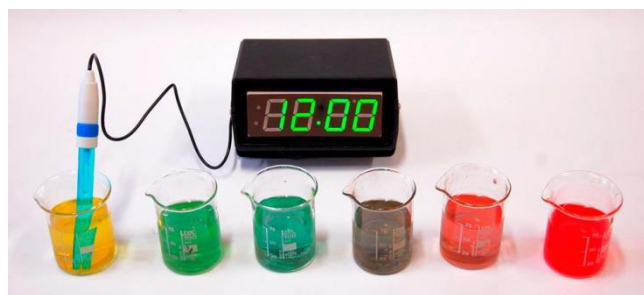
Рисунок 2. Настройка демонстрационного рН-метра со светодиодным отображением значений рН.
